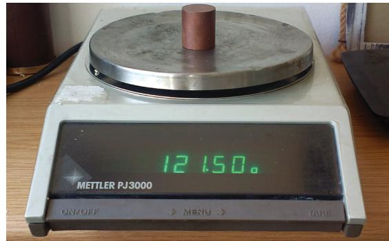
Φωτογραφία 2 Ζυγού κατά τη μέτρηση όπου τοποθετείται το προς ζύγιση σώμα και διαβάζεται η ένδειξη της μάζας του σώματος σε g.
