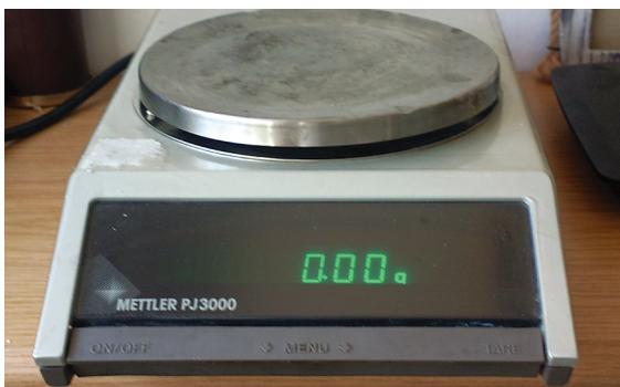
Φωτογραφία 1 Ζυγού πριν τη μέτρηση όπου μηδενίζεται η ένδειξη με το πάτημα της γκρίζας μπάρας στο κάτω μέρος από την οθόνη του ζυγού.
